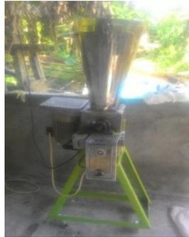
Gambar 3. Alat blender-mixer kapasitas 20L, hasil rekayasa pengusul
