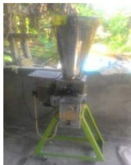
Gambar 3. Alat blender-mixer kapasitas 20L, hasil rekayasa pengusul
