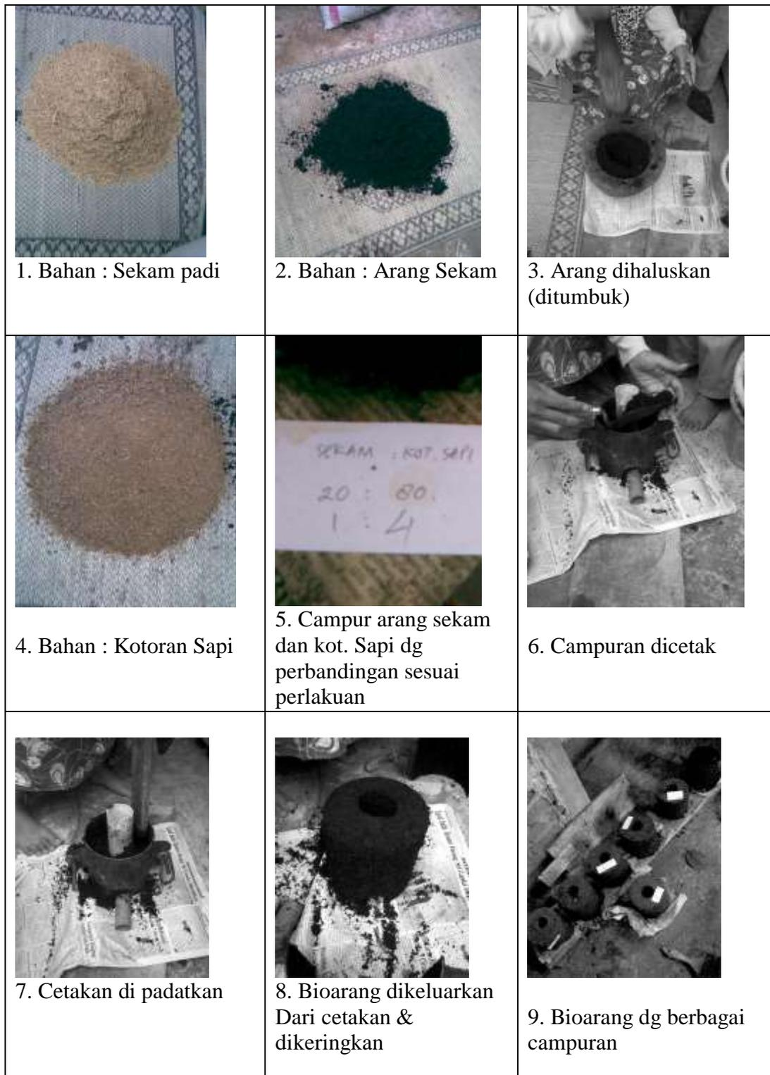
Gambar 3. Skema Urutan Pembuatan Briket
