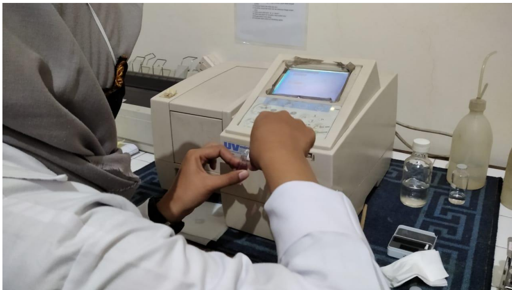
Gambar 4. Pengujian sifat fungsional (RSA) bakso daging Itik dengan spektrofotometer.
