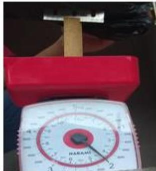
**Gambar 4.** Pengujian Gaya Pemotongan
