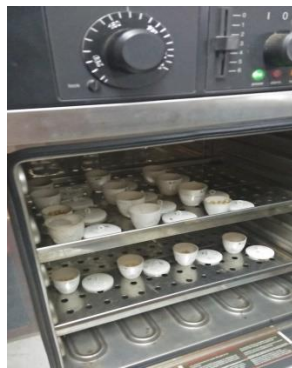
Gambar 21. Pengovenan untuk kadar air dengan suhu 130°C selama 2,5 jam
